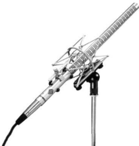
**Figura 5.9** El Neumann KMR 82 es un micrófono de cañón con una alta direccionalidad que permanece dentro del ángulo de aceptación independiente de la frecuencia.
